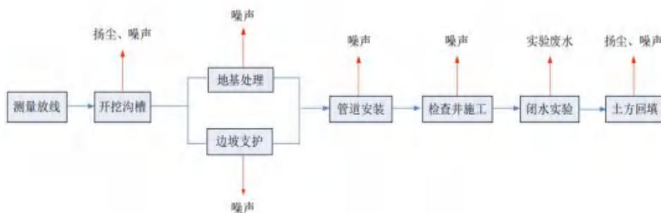
图 3.2-6 管线工程施工期工艺流程图
