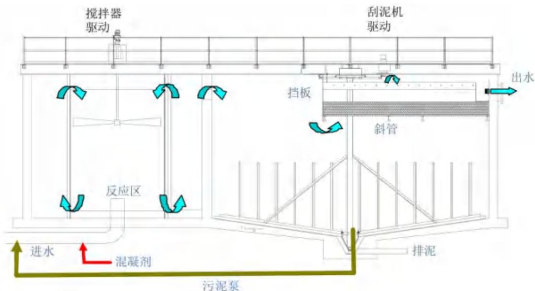
图 3.2-5 高效沉淀池工艺流程示意图
