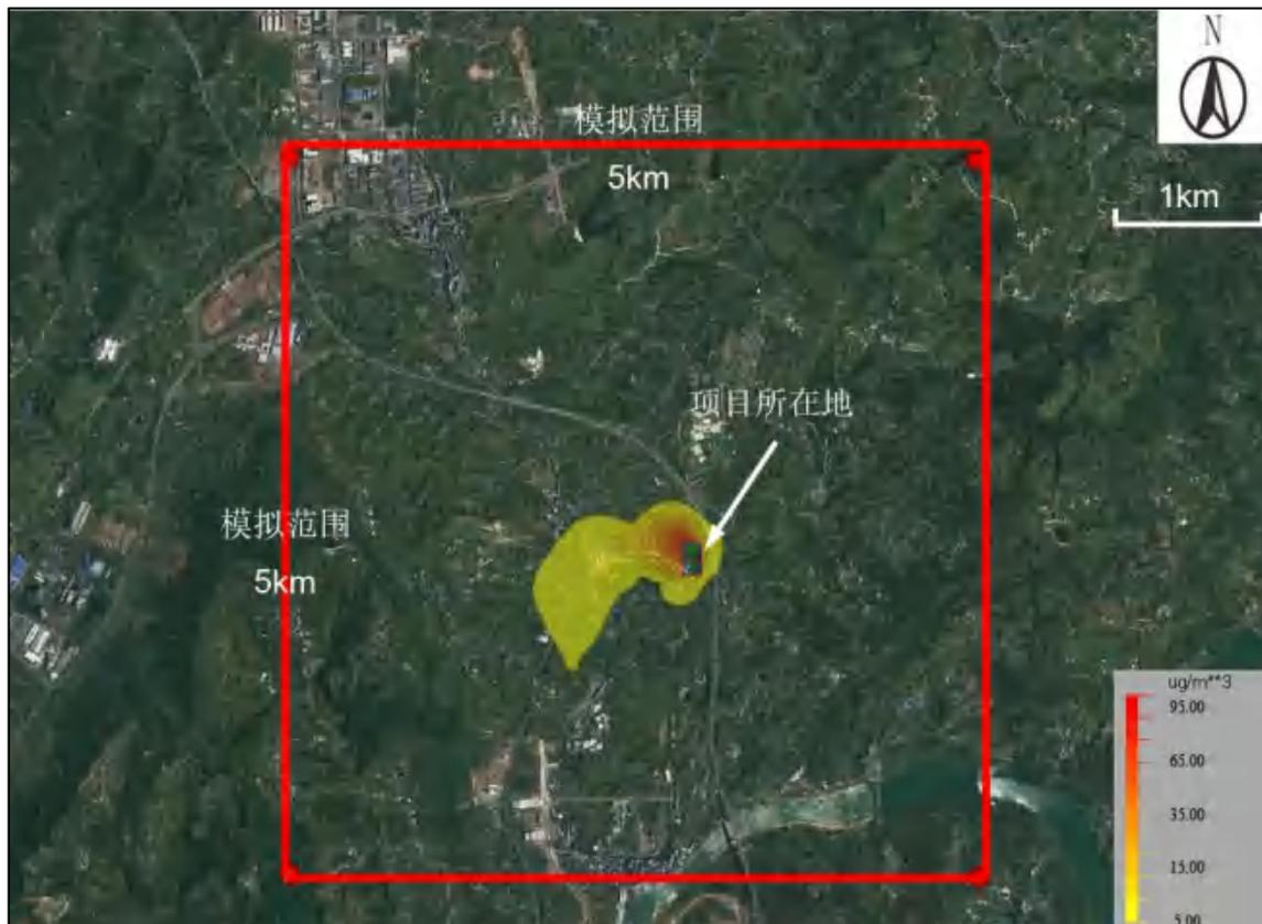
图 6.2-20 非正常排放工况下  $\text{NH}_3$  最大短期（1 小时）浓度贡献值分布图（单位： $\mu\text{g}/\text{m}^3$ ）
