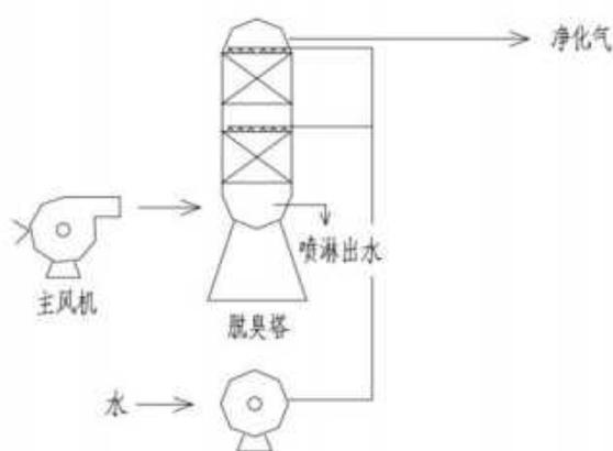
图 8.1-1 生物滤池脱臭工艺流程图
