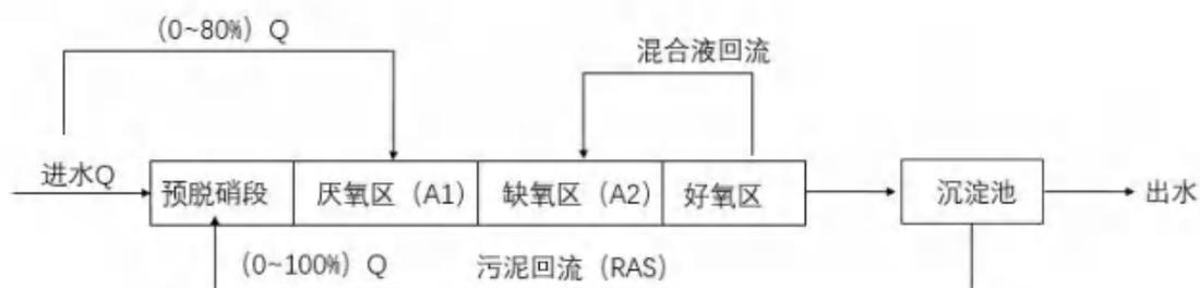
图 3.2-3 改良 A/A/O 法工艺流程图
