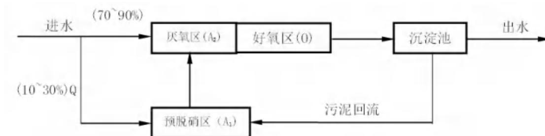
图 3.2-2 改良型 A/O 法工艺流程图
