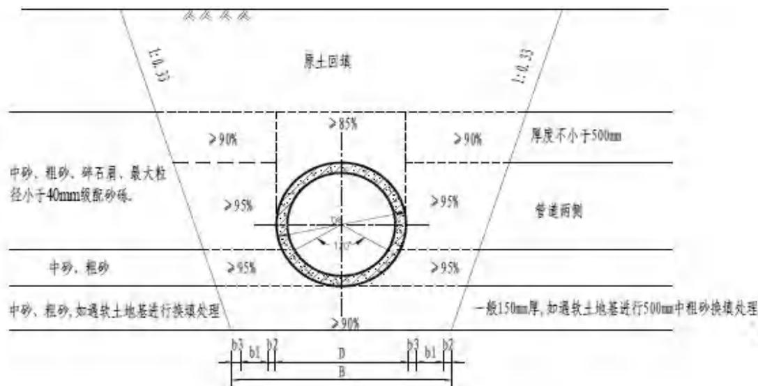
图 3.2-7 管道沟槽开挖回填剖面图
