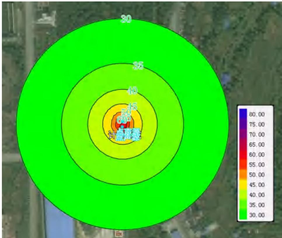
图 6.3-2 项目泵站噪声等声线
