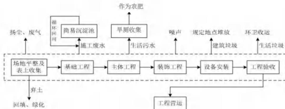
图 3.2-8 污水处理厂施工期工艺流程图
