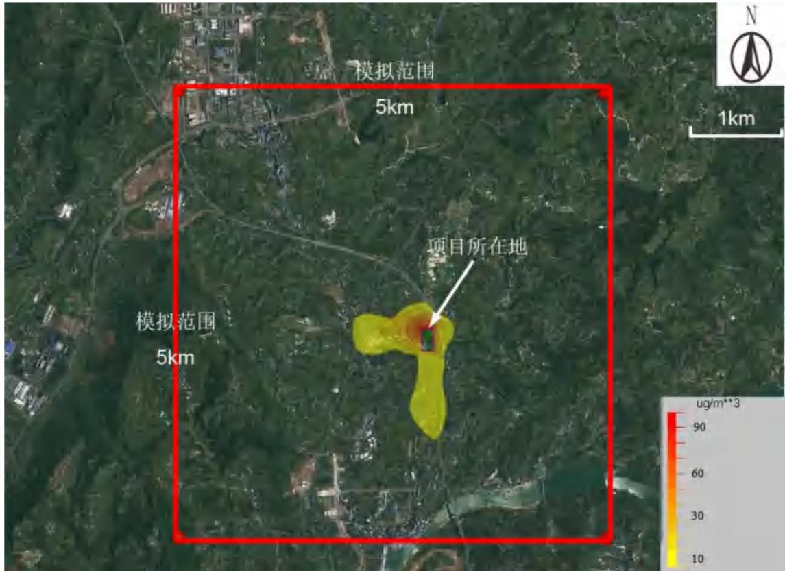
图 6.2-19 正常排放工况下  $\text{NH}_3$  最大短期（1 小时）浓度贡献值分布图（单位： $\mu\text{g}/\text{m}^3$ ）
