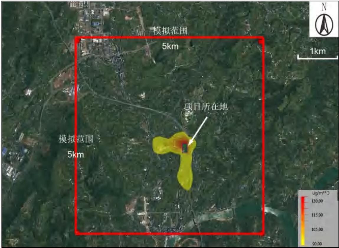
图 6.2-21 叠加现状浓度后正常排放工况  $\text{NH}_3$  最大短期 (1 小时) 质量浓度分布图 (单位:  $\mu\text{g}/\text{m}^3$ )
