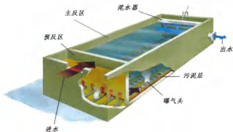
图 3.2-4 CASS 反应器基本构造
